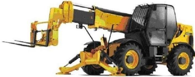
Manipulador Telescópico – Capacidade de carga de 3500 kg. Altura máxima de elevação 12300 mm. Potência do motor 85 HP.
