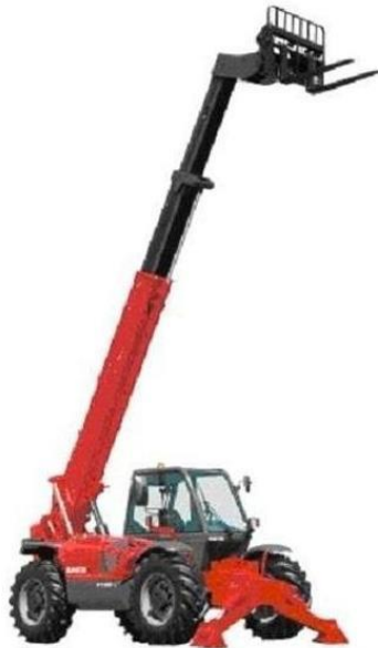
Manipulador Telescópico –Capacidade de carga de 3500 kg. Altura máxima de elevação 12000 mm. Potência do motor 101 HP
