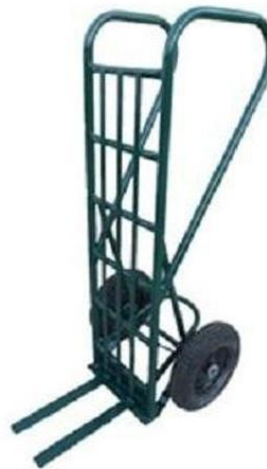
Carrinho para mini páletes – Capacidade de carga de 350 kg.
