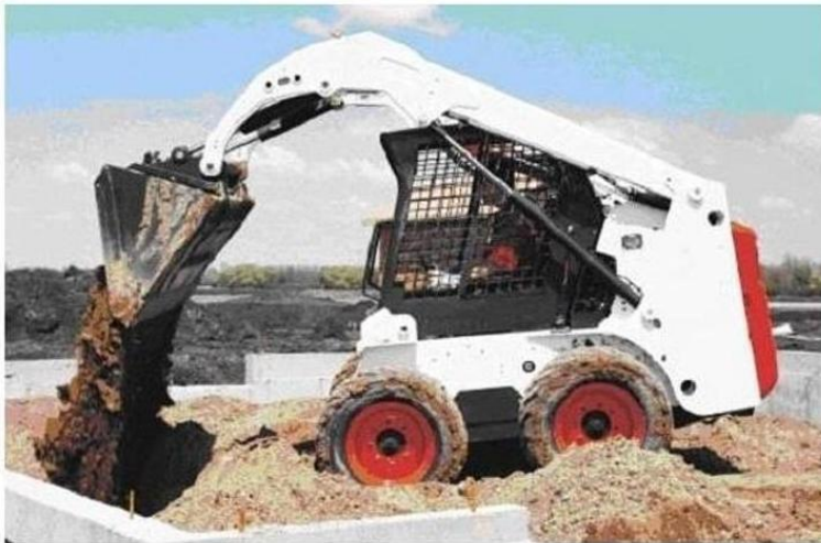
Minicarregadeira – Capacidade nominal de carga 2692 kg. Capacidade da caçamba coroada 400 L. Potência do motor 49 HP
